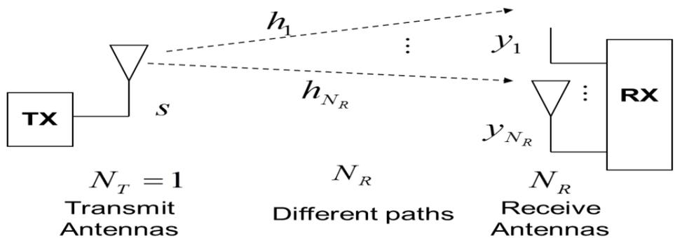
$$\begin{bmatrix} y_1 \\ \vdots \\ y_{N_R} \end{bmatrix} = \begin{bmatrix} h_1 \\ \vdots \\ h_{N_R} \end{bmatrix} \sqrt{E_S} s + \sqrt{N_0} \begin{bmatrix} w_1 \\ \vdots \\ w_{N_R} \end{bmatrix}$$
