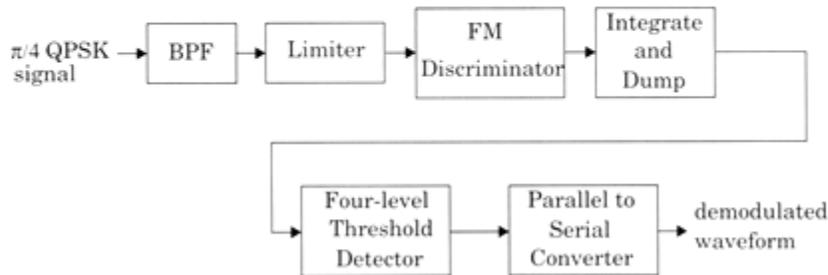
Figure : FM discriminator detector for  $\pi/4$  DQPSK demodulation.
